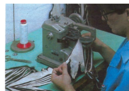
COSIDO EN MÁQUINA ESPECIAL EN UNA PIEL CORTADA DE VISÓN PARA SU ALARGUE.
